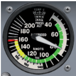
Figur 2.9: Der Fahrtmesser in der Cessna 172 [Vollbild!]
