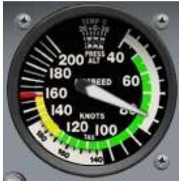
**Figura 2.7:** L'indicatore di velocità relativa nel Cessna 172
