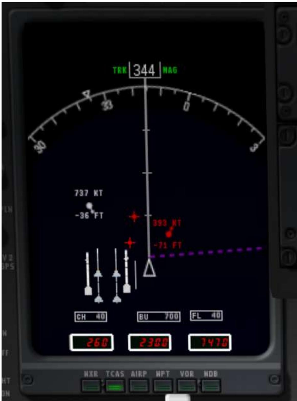
**Figura 8.9:** lo schermo EFIS con un bersaglio selezionato che si trova a circa 30 gradi a destra, di fronte l'aereo e viaggia a 393 kts
